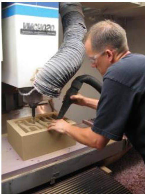
Obr. 2.3b – Proces odsávání uvolněných zrn písku
