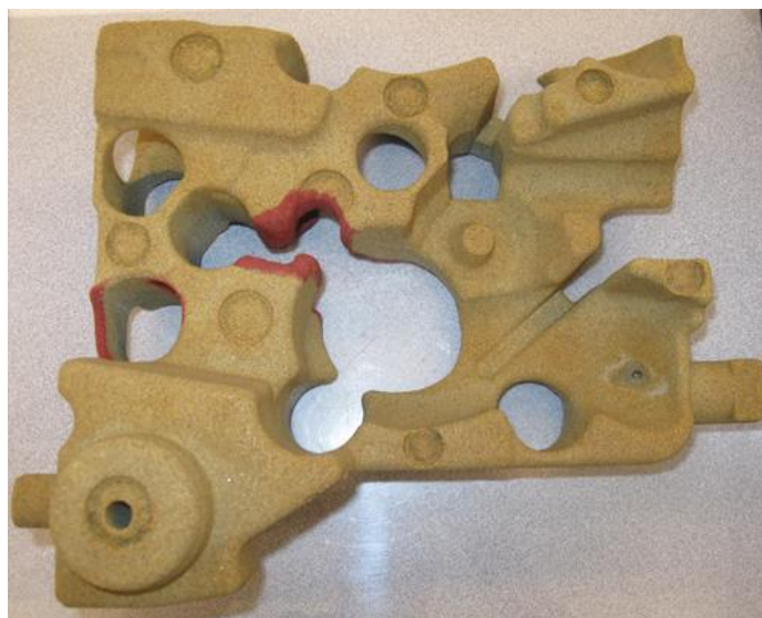
Obr. 2.3c - Doplnkové úpravy formy jsou vyznačeny červeně (11)
