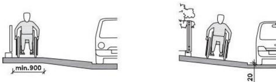
Obrázek 4 - Správné a špatného provedení příčného sklonu.
