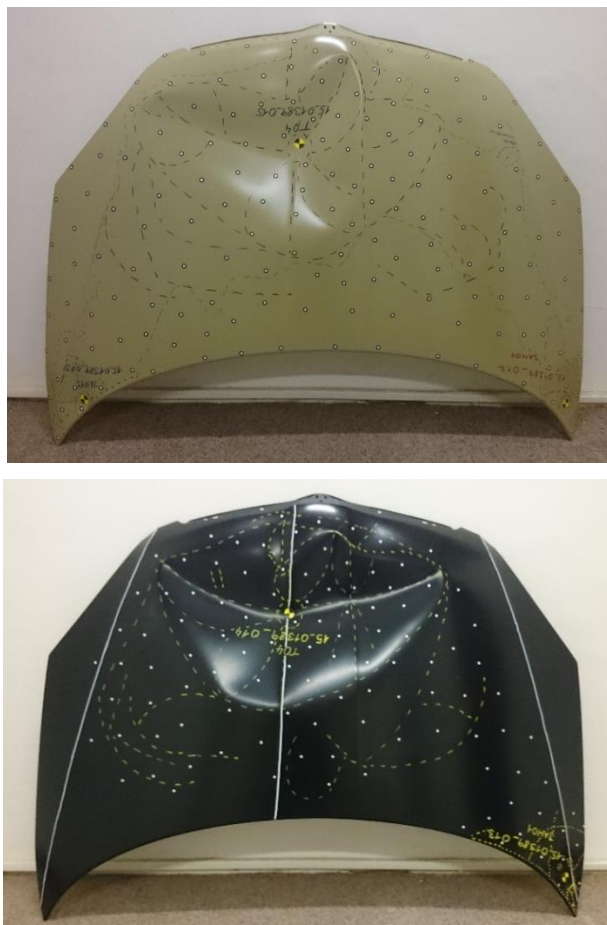
Obr. 41 - Originální a neoriginální kapoty polepené pozičními terči
