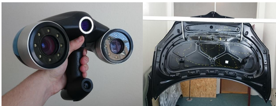
Obr. 42 - Skener Creaform VIUscan Handyscan; Závěs kapot pro potřeby měření
