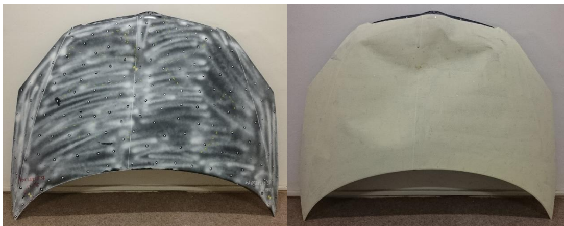
Obr. 51 - ošetření povrchu neoriginálních kapot, křídovým sprejem vpravo; béžovou barvou vlevo
