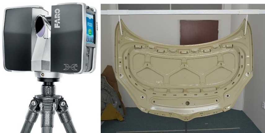
Obr. 31 - Skener Faro FOCUS 3D; Závěs kapot pro potřeby měření
