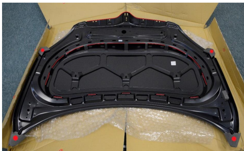
Obr. 29 - Originální díl - vyznačení ostrých hran
