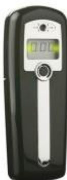
Obrázek 8 - Ukázka polovodičového alkoholtesteru AL 2500® Black (51)
