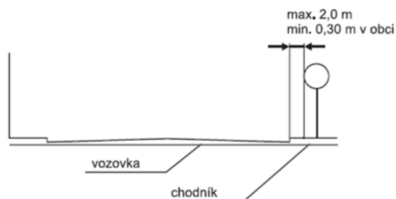
Obrázek 17 - Boční umístění dopravního značení v obci [5]
