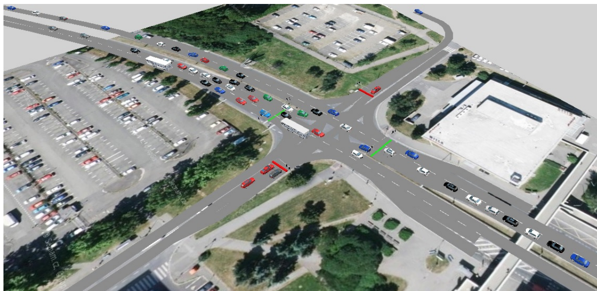
Obr. 27: Dvoufázová verze signálního plánu v simulaci po přepnutí volno pro hlavní PK
