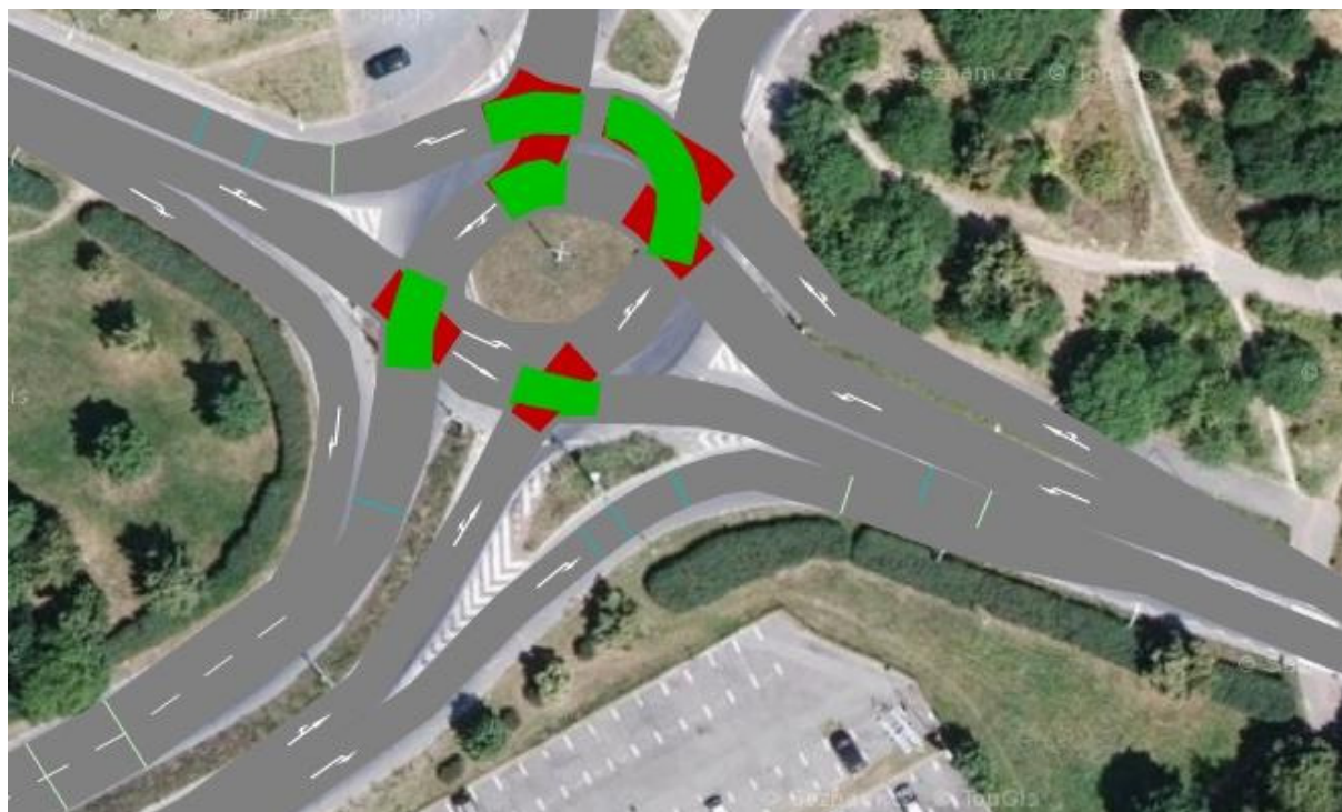
Obr. 24: Návrh turbookružní podoby křižovatky Výstavní x Opatovská s vyznačením předností Na obrázku 24 je vidět její podoba na podkladu současné ortofotomapy. Šířka pruhů v křižovatce je 5 metrů a je zachován minimální poloměr definovaný původním ostrovem.
