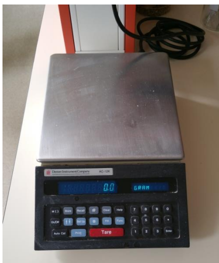
Obrázek 62: Digitální váha s přesností 0,1g Zdroj: Autor, laboratoř D1035, ČVUT
