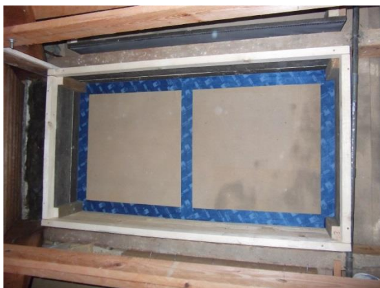
Obrázek 30: Utěsnění vzorku: TESCON VANA 1 Zdroj: Autor
