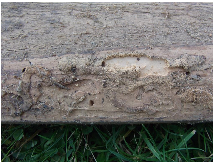
Obrázek 5: Dřevo napadané dřevokazným hmyzem Zdroj: Autor
