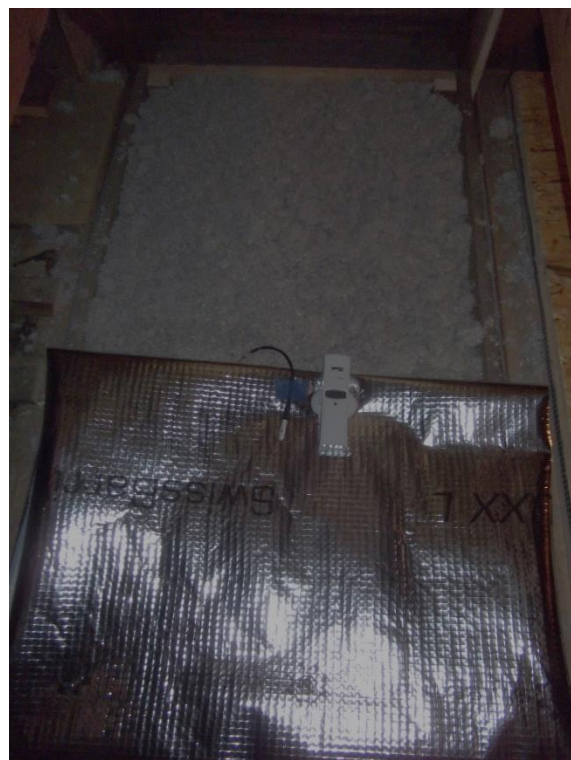
Obrázek 65: Umístění čidel pod fólií Zdroj: Autor
