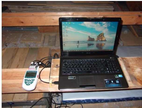
Obrázek 69: Propojení dataloggeru s PC
