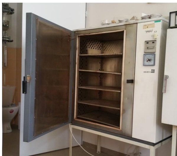
Obrázek 63: Vysoušecí pec Zdroj: Autor, laboratoř D1035, ČVUT
