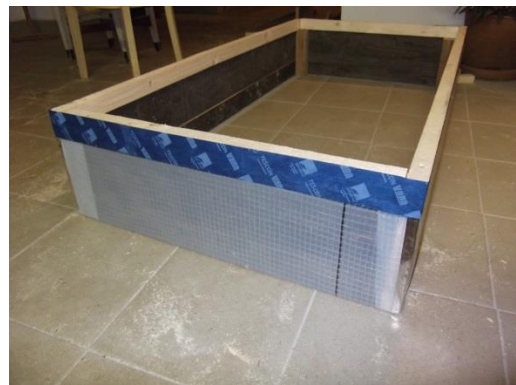
Obrázek 51: Utěsnění čel vzorku
