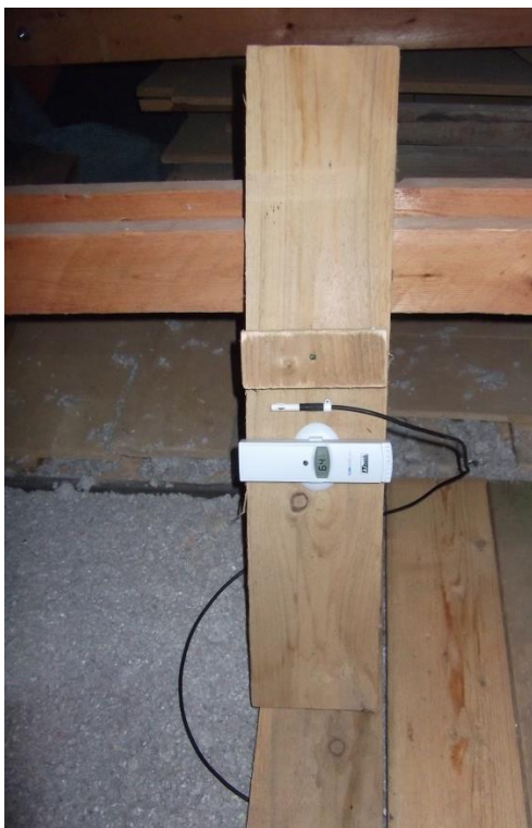
Obrázek 64: Umístění čidel pod prkny Zdroj: Autor
