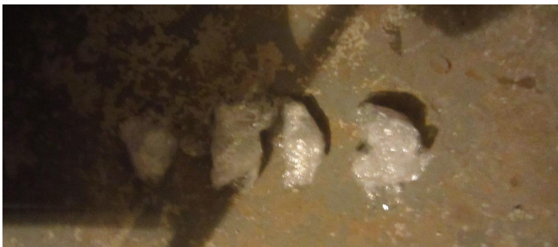
Obrázek 60: Důkladné, těsné zabalení vzorků pro převoz do laboratoře (foto autorka 10. 3. 2016)
