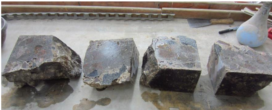
Obrázek 75: Vzorek rozdělen na čtyři podobně velké kubické formáty (foto autorka 24. 4. 2015)
