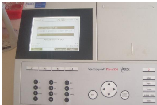
Obrázek 54: UV – VIS fotometr Spectroquant Pharo 300 (foto autorka 22. 3. 2016)
