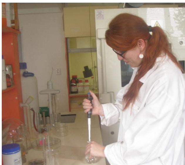
Obrázek 56: Přesné odměření všech použitých látek pomocí automatické pipety (foto autorka 22. 3. 2016)
