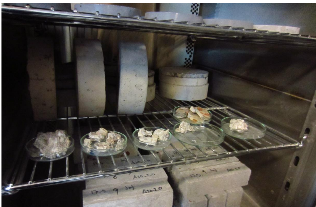
Obrázek 61: Odebrané vzorky pro zjištění hmotnostní vlhkosti v sušárně (foto autorka 10. 3. 2016)
