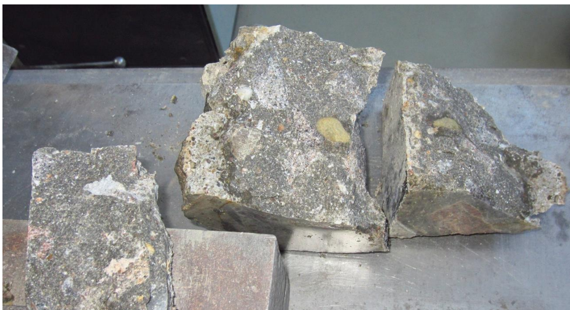
Obrázek 80: Rozštípnutý referenční vzorek bez nátěru (foto autorka 28. 4. 2016)
