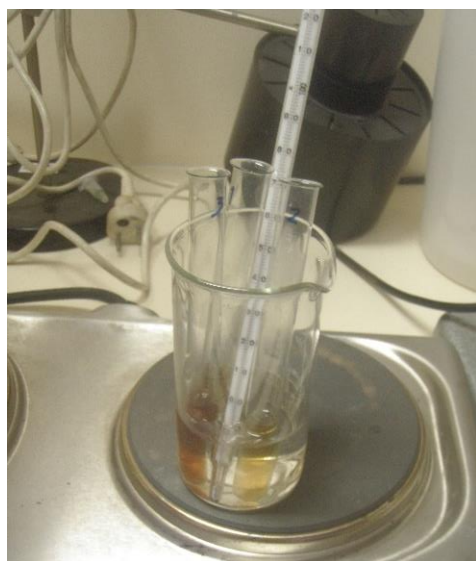
Obrázek 55: Temperování roztoku pro testování síranů (foto 22. 3. 2016)
