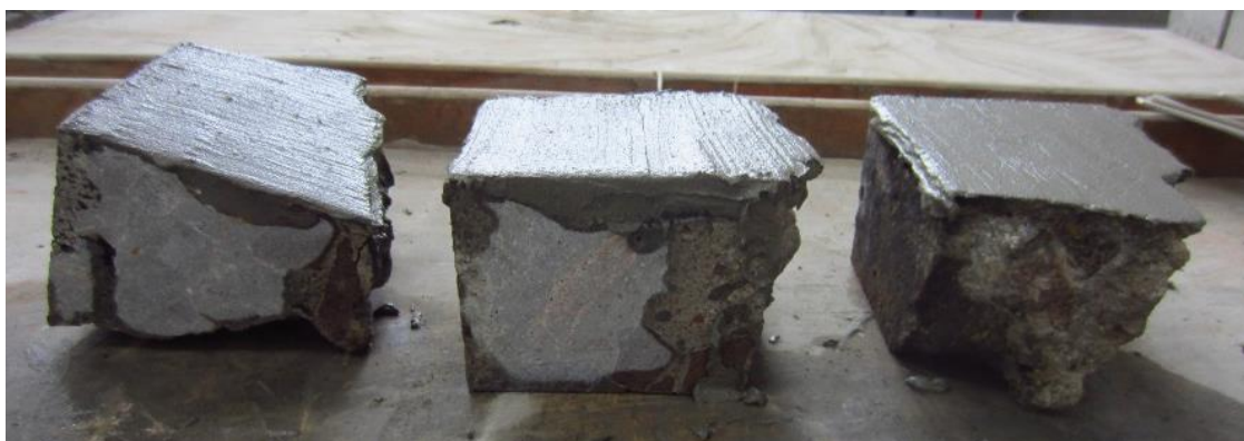
Obrázek 76: Tři ze čtyř vzorků byly opatřeny krystalizačním nátěrem (foto autorka 24. 4. 2015)
