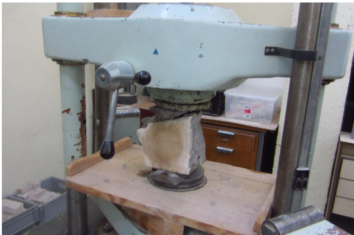
Obrázek 79: Rozdělení vzorku s nátěrem pro posouzení hloubky průsaku (foto autorka 28. 4. 2016)
