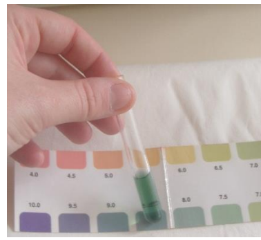
Obrázek 49: Vzorek 3 - pH 8 (foto autorka 22. 3. 2016)
