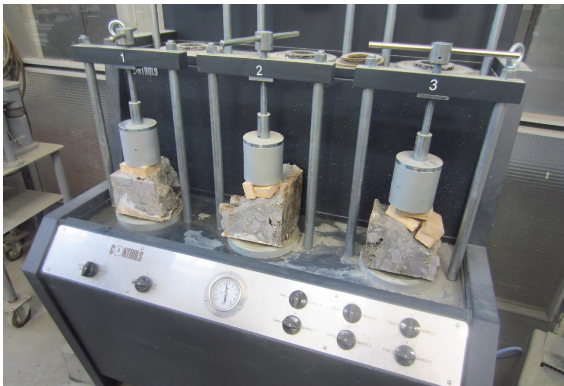
Obrázek 78: Vodotlačná stolice s měřenými vzorky, zleva dva s nátěrem a poslední referenční bez nátěru (foto autorka 25. 4. 2016)
