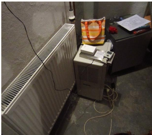
Obrázek 71: Datalogger COMET pro teplotu a vlhkost, snímač CO 2 ; měřeno v ubikaci (foto autorka 10. 3. 2016)
