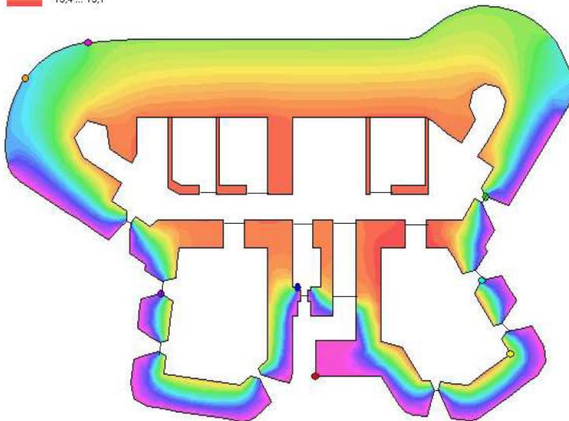
Obrázek 65: Model 2D teplotního pole v 1. NP ( Area 2015.1 )
