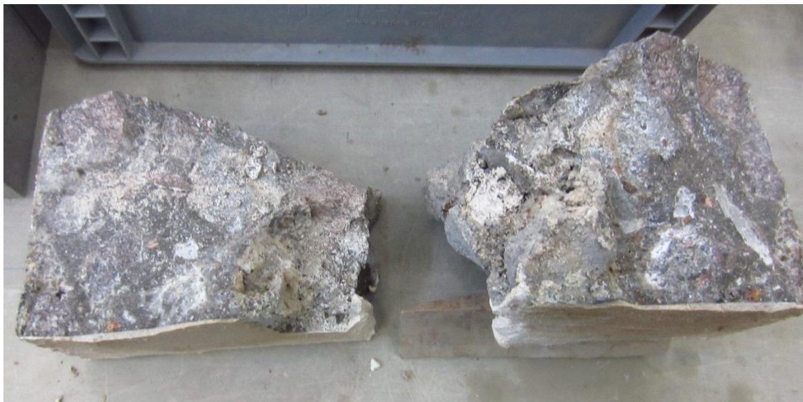
Obrázek 81: Vzorek s nátěrem po 72 hodinách ve vodotlačné stolici (foto autorka 28. 4. 2016)
