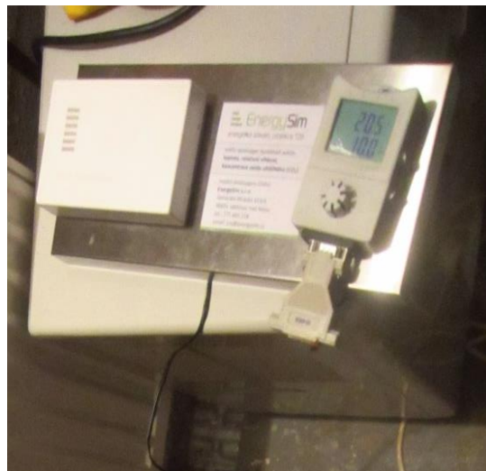
Obrázek 72: Datalogger COMET pro teplotu a vlhkost, snímač CO 2 (foto autorka 10. 3. 2016)
