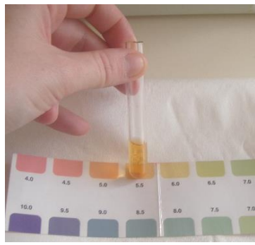
Obrázek 48: Vzorek 2 - pH 5,5 (foto autorka 22. 3. 2016)
