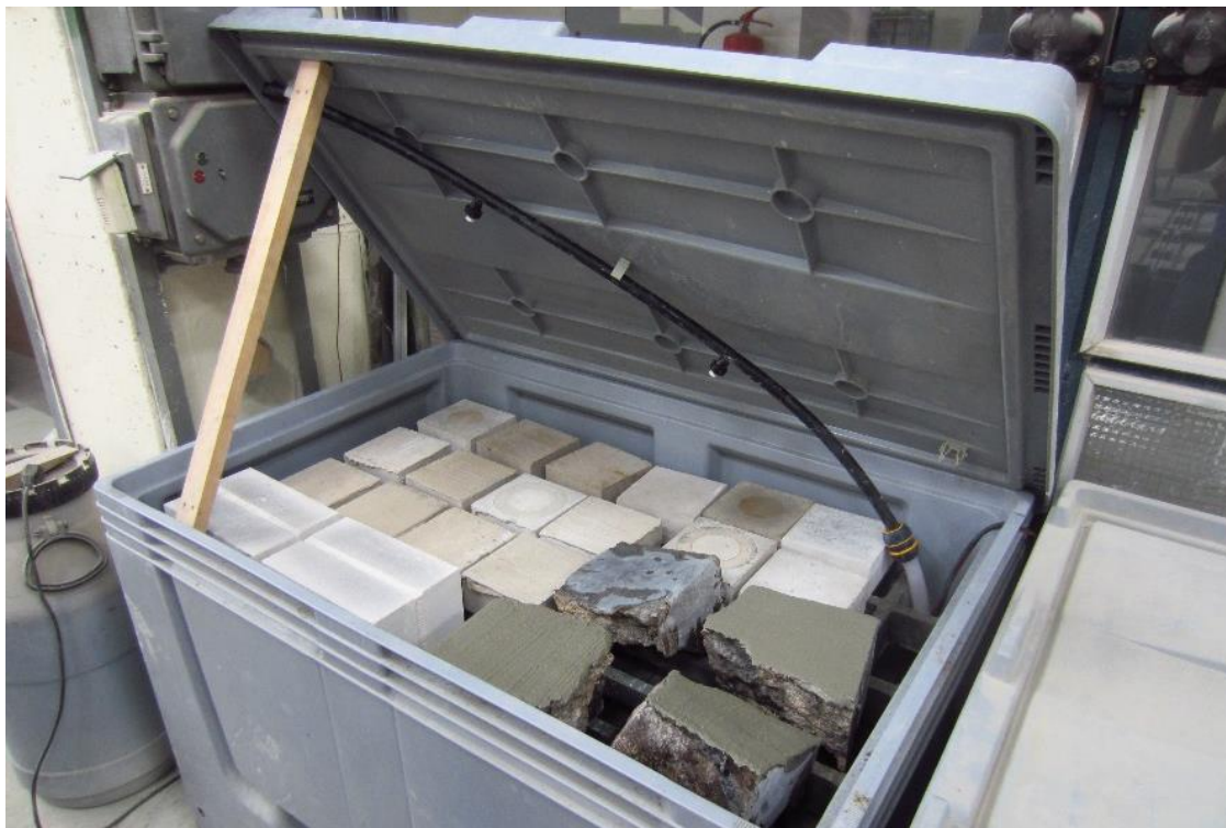
Obrázek 77: Nátěr se nechá na vzorcích působit ve speciální nádobě (foto autorka 24. 4. 2015)
