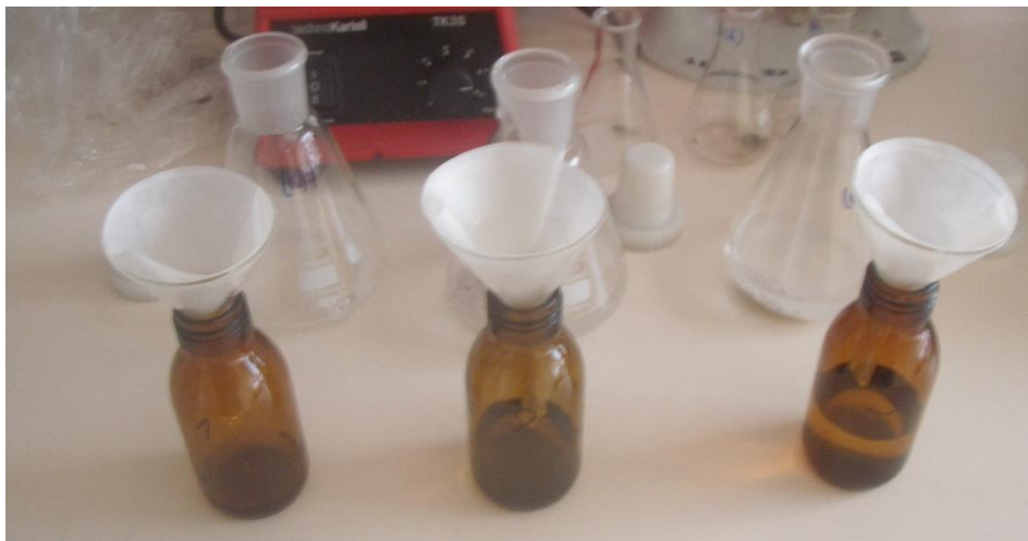
Obrázek 52: Filtrace vzorků přes papírový filtr (foto autorka 22. 3. 2016)
