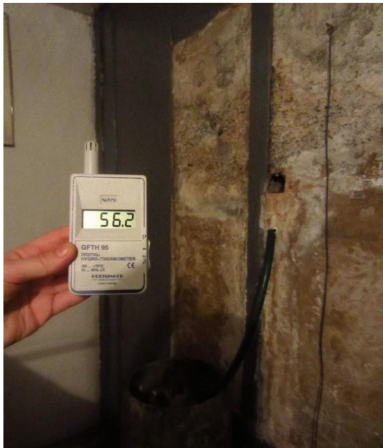
Obrázek 63: Ruční digitální vlhkoměr/teploměr GRESINGER GFTH 95, měření v ubikaci (foto autorka 10. 3. 2016).
