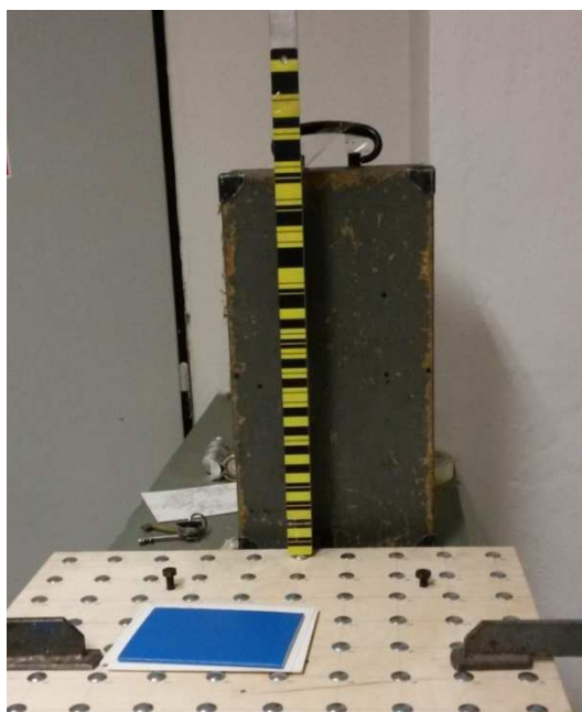
Obr. 16: Upevněný pruh kódované invarové latě
