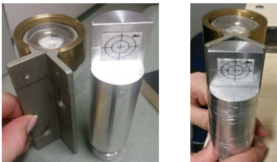
Obr. 9: Odrazný štítek Leica, válec, krabicová libela
