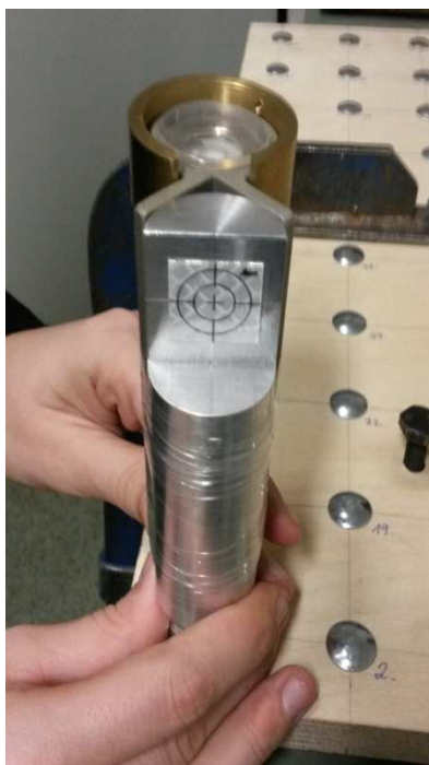
Obr. 15: Průběh měření totální stanicí na odrazný štítek Leica
