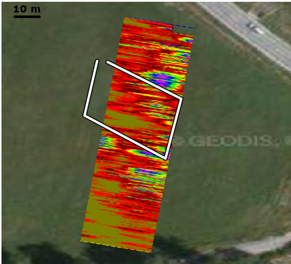
Obrázek 55: Řez 3D obrazem vyinterpolovaného z měření georadarem v hloubce 1,08 m pod povrchem.[mapy.cz]
