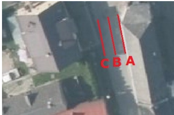
Obrázek 38: Zvolené profily pro měření georadarem nad hlavní chodbou. [ČÚZK, QGIS]
