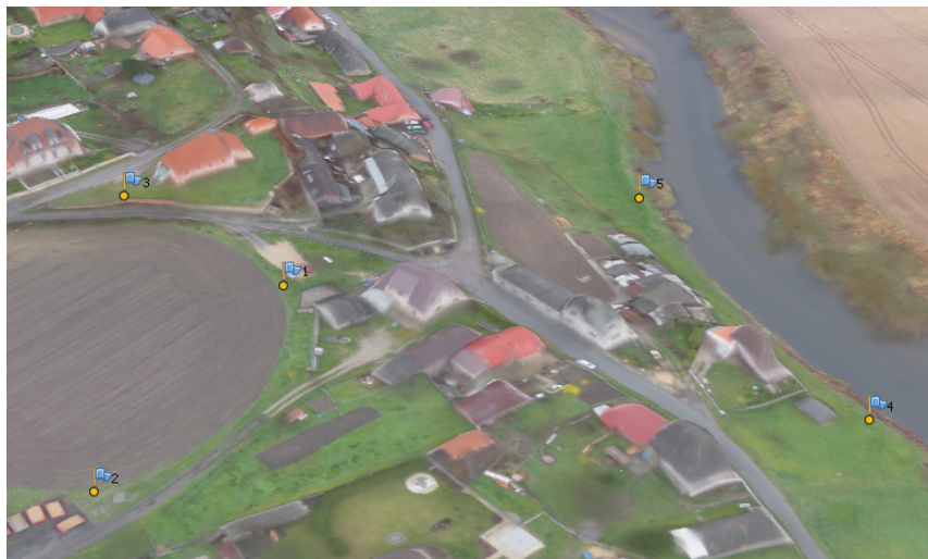
Obrázek 44: Vytvořený otexturovaný 3D model s rozmístěním vlčovacíků bodů.
