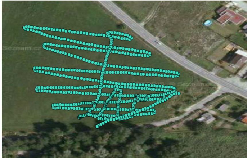
Obrázek 49: Měření magnetometrem nad zájmovou oblastí (každý bod odpovídá jednomu měření).[mapy.cz]
