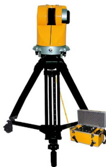
Obrázek 16: Příklad staršího impulsního laserového skeneru Callidus CP3200. [6]
