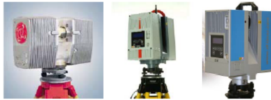
Obrázek 18: Fázové laserové skenery. [12]
