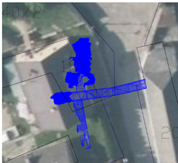
Obrázek 36: Soukres ortofota, katastrálních dat a 3D modelu z geodetického zaměření. [ČÚZK, QGIS]
