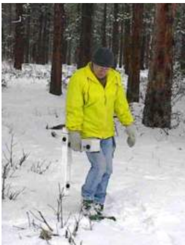
Obrázek 11: Magnetometr s ferosondou. [1]
