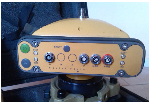
Obr. 5.3: GNSS přijímač Topcon HiPer+, přední strana
