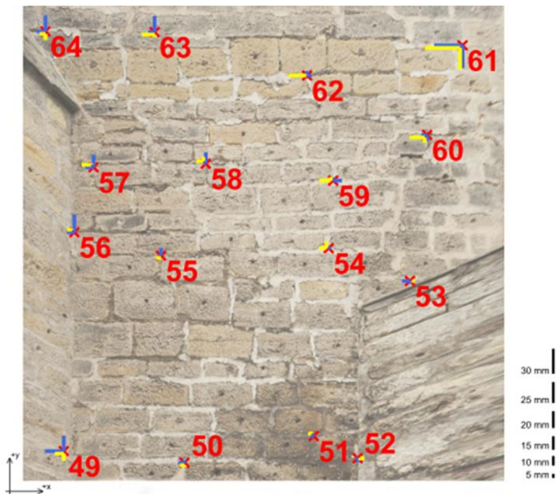
Obr. 32: Výřez výkresu R4 – téměř ideální situace snímkování – porovnání testovaných softwarů
