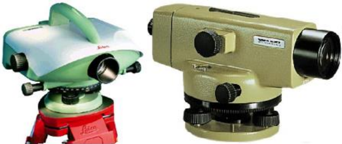
Obrázek 5: používané nivelační přístroje (zprava Leica DNA03, Wild NAK2)
