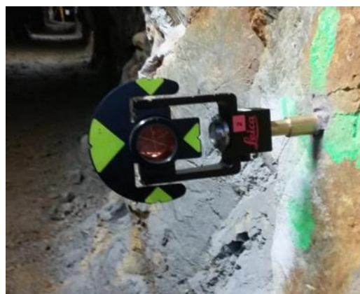
Obr. 7: Signalizovaný trn odrazným minihranolem Leica GMP101
