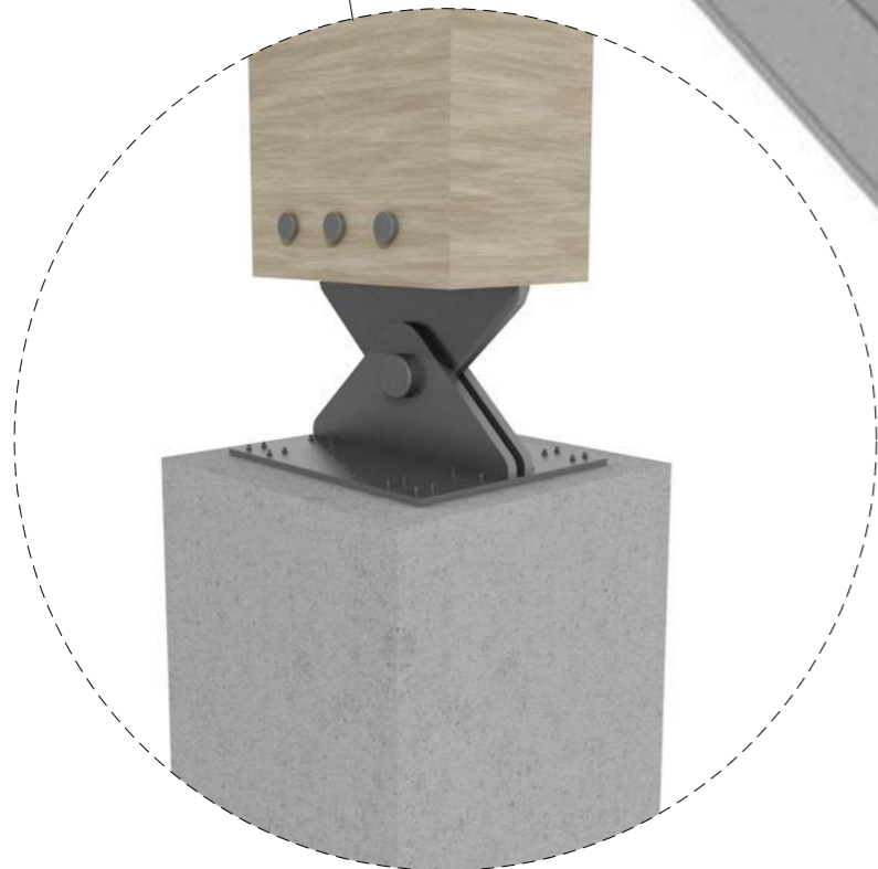
Kloubové uložení dřevěných lepených nosníků
