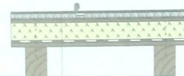
Obr.6 — Drážková krytina (titanzinek, pozink, měď, nerez) — Strukturální rohož+hydroizolace — puren PIR Compact/QSB — puren PIR FD-XL/QSB — puren PIR Plechová střecha — Parozábrana Sd>100m — Bednění
