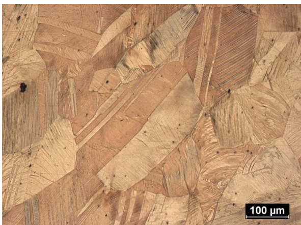
Obrázek 37: CuSn8, podélný řez.
