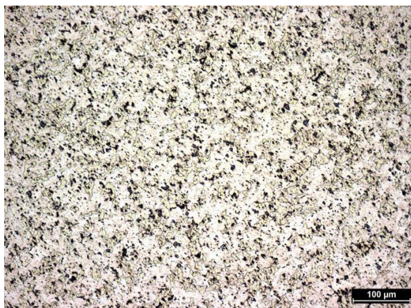
Obrázek 31: AlCu4PbMg, příčný řez.
