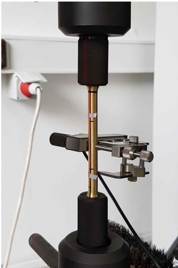
Obrázek 22: Vzorek se značkami upnutý v závitových čelistech s nasazeným extenzometrem MSQ-R1.
