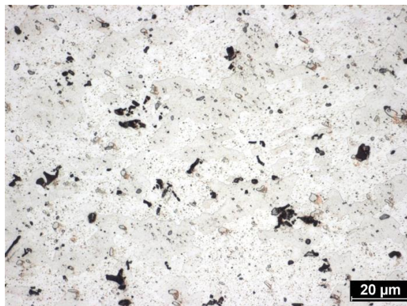
Obrázek 32: AlCu4PbMg, příčný řez 2.
