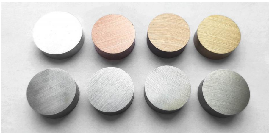
Obrázek 18: Broušené vzorky z větších tyčí určené pro ověření metodiky stanovení vlastností.
