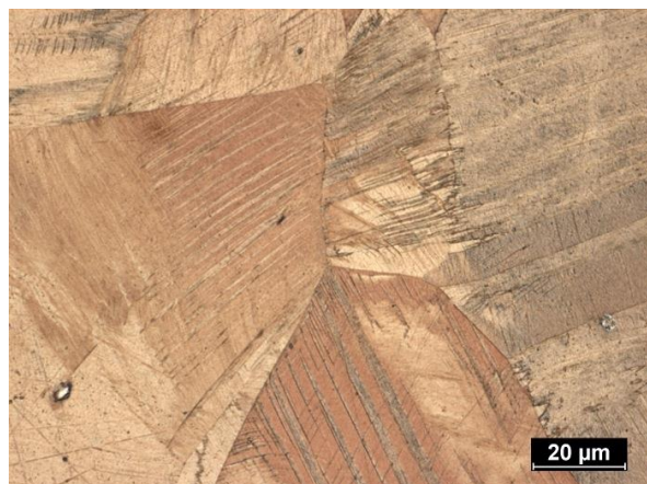
Obrázek 38: CuSn8, podélný řez 2.
