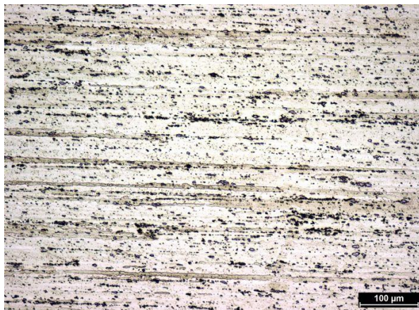
Obrázek 29: AlCu4PbMg, podélný řez.
