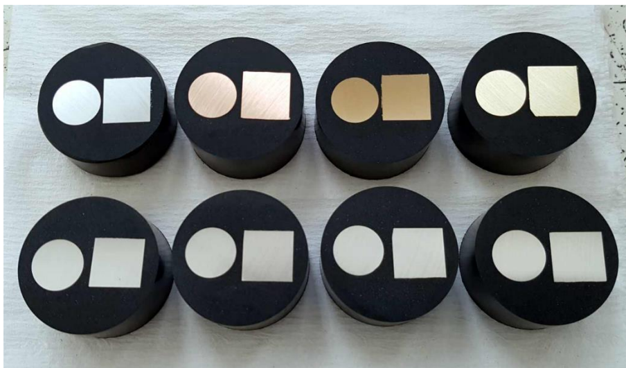
Obrázek 19: Broušené vzorky s příčným a podélným směrem zalisované do lisovací hmoty.
