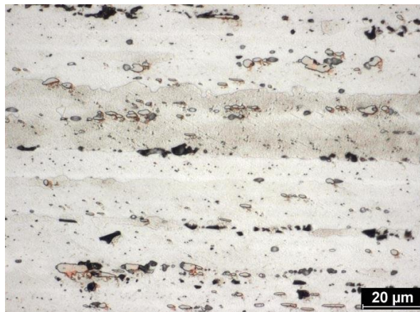
Obrázek 30: AlCu4PbMg, podélný řez 2.
