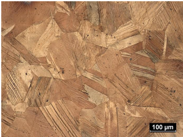
Obrázek 39: CuSn8, příčný řez.
