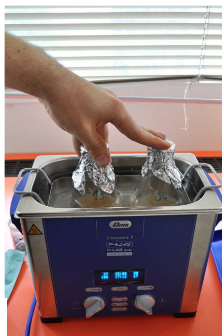
Obrázek 120: Příprava vzorku, vystavení směsi ultrazvuku a horké vodní lázni, foto: autor, duben 2016
