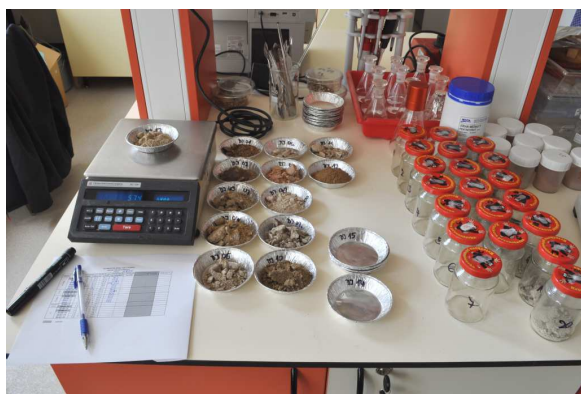
Obrázek 71: Vlhkostní analýza odebraných vzorků, fáze vážení vzorků, foto: autor, duben 2016
