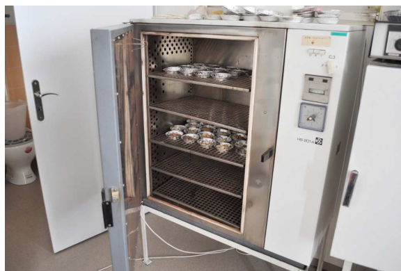
Obrázek 116: Sušení vzorků v sušárně, foto: autor, duben 2016
