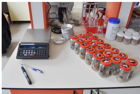
Obrázek 115: Příprava k vážení vlhké zkušební navážky, foto: autor, duben 2016
