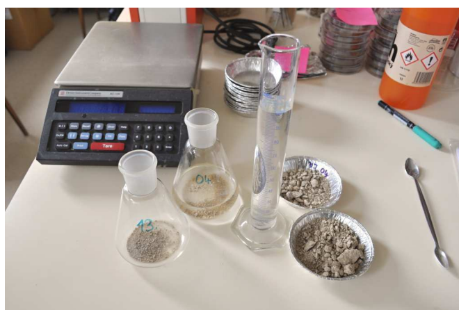
Obrázek 119: Příprava vzorku, zalití navážky destilovanou vodou, foto: autor, duben 2016
