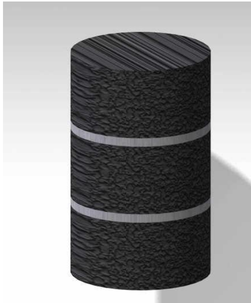
obr. 22: střídání pelet \text{UO}_2 a vrstev jiného materiálu
