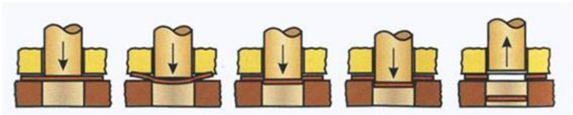
Obrázek 6 Princip stříhání pomocí stříhadla [27]
