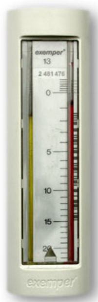
Obr. 2.2 Indikátor na principu odparu – dvoukapilárový [15]
