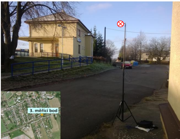
Obr. 11: Umístění mikrofonu zvukoměru během terénního měření [3]
