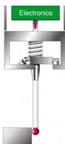
Obr. 1-14: Schéma tenzometrického snímacího systému [1]
