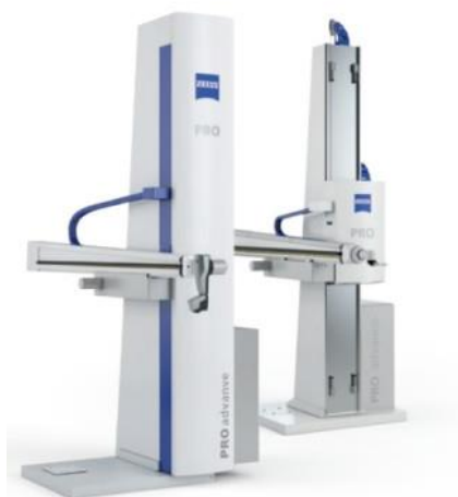
Obr. 1-3: Stojanový typ CMM – Zeiss PRO Horizontal Arm [8]
