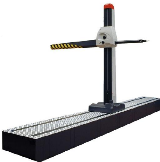
Obr. 1-4: Výložníkový typ CMM – Coord 3 Swan runway model [9]
