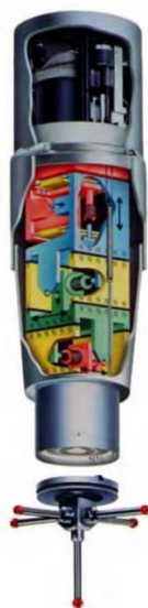
Obr. 1-15: Analogový skenovací systém Zeiss [1]
