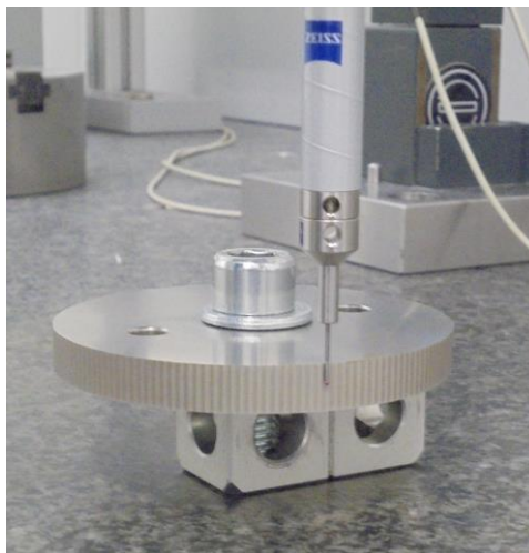
Obr. 4-26: Etalon se superponovanými frekvencemi [39]
