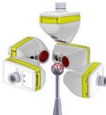
Obr. 4-14: Pozice laser scanneru vůči měřené kouli [16]
