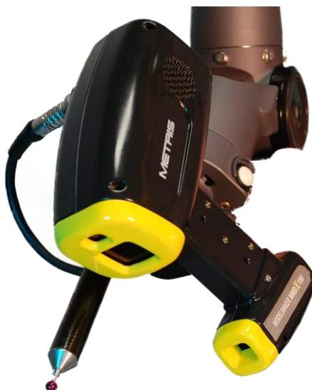
Obr. 1-27: Scanner Nikon MMDx 100 na mobilní měřicí ramena [12]
