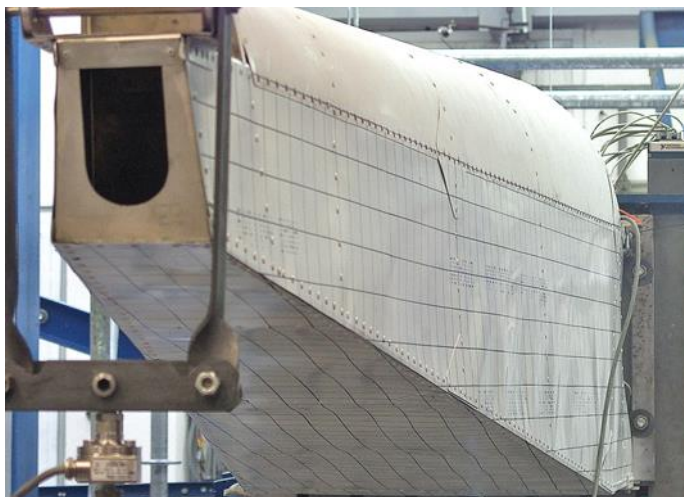
Obr. 5-12: Potahové plechy po ztrátě stability
