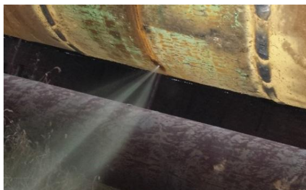
Obr. 5.4 Tlaková zkouška únosnosti obvodových svarů [43]
