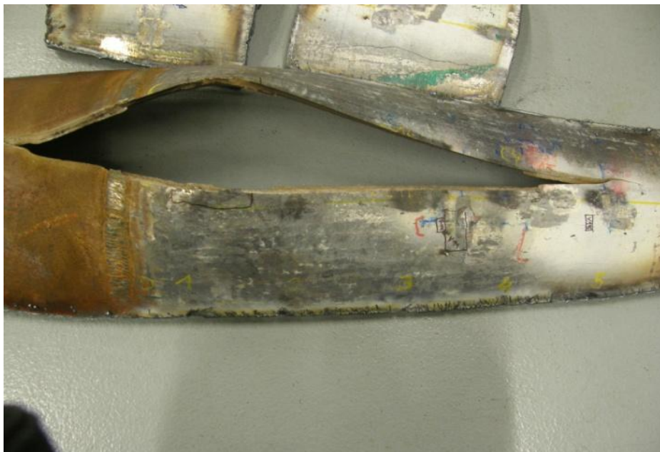
Obr. 8.2 Oblast iniciace trhliny a nejbližší trhlina č. 14
