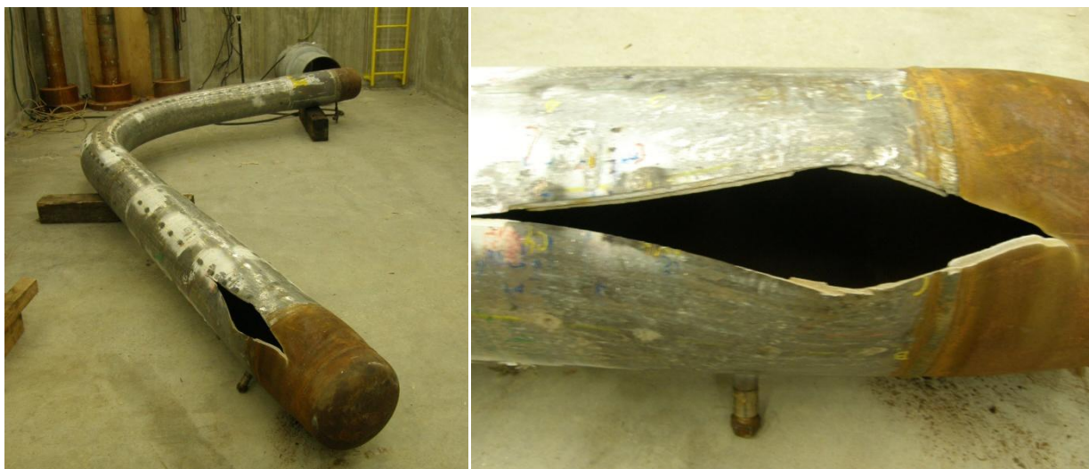
Obr. 8.1 Trubka DN300 po destrukci
