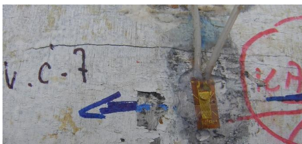
Obr. 7.1 Ilustrativní obrázek umístění tenzometru na indikované vadě č. 7
