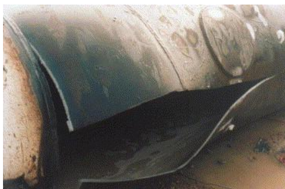
Obr. 5.3 Tlaková zkouška únosnosti záplat [42]
