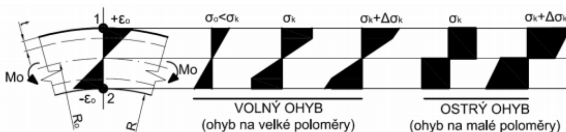
Obr. 3.6 Průběh napětí při ohybu [15]
