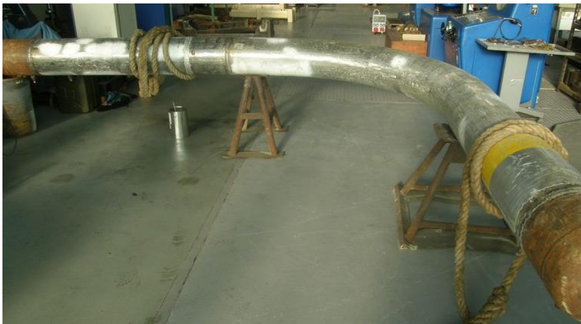
Obr. 6.3 Dva svařené segmenty DN300 se dny pro tlakovou zkoušku
