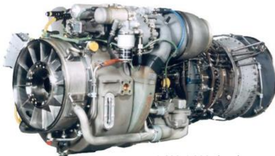
Obrázek 8: Motor GE T700-401C/701C. [23]
