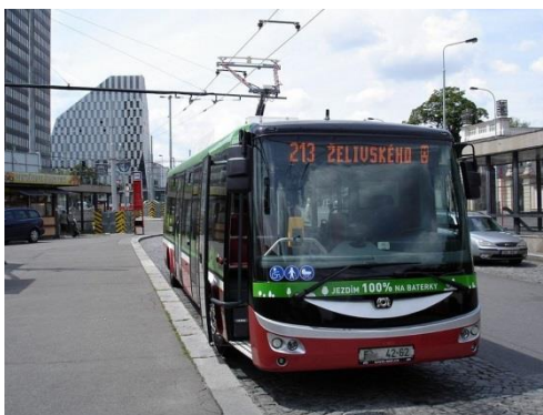
Obrázek 35 - SOR EBN 11 v testovacím provozu při nabíjení akumulátoru z trolejového vedení [61]
