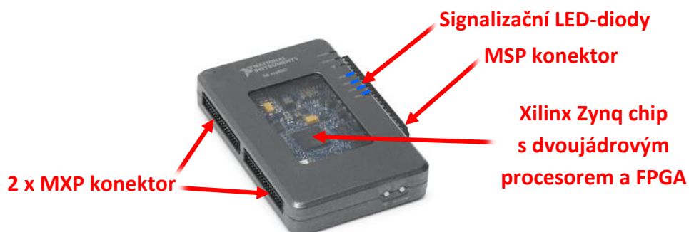
Obrázek 29: Řídicí počítač NI myRIO; zdroj: (15)
