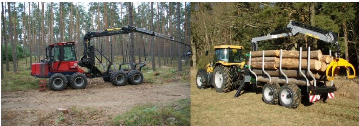
Obr. 3. Vyvážecí traktor Valmet 830 (vlevo) a vyvážecí souprava s hydraulickou rukou Kesla 304 [2]
