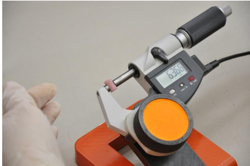
Obr. 3.6 Zaznamenávání rozměrů vzorků mikrometrem.
