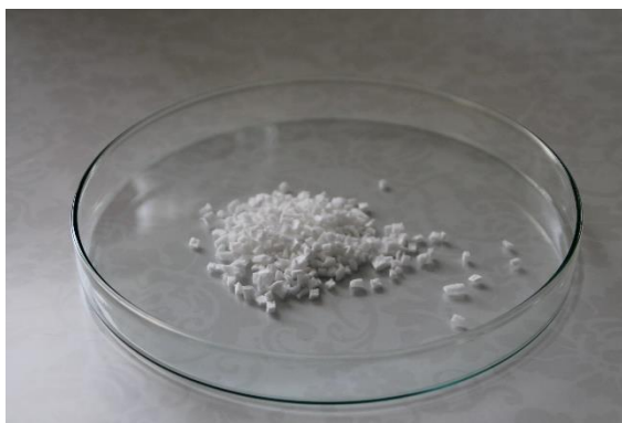
Obr. 3.1 Pro snadnější přípravu disperze je lyofilizovaný kolagen nejprve nastříhán na drobné kousky.
