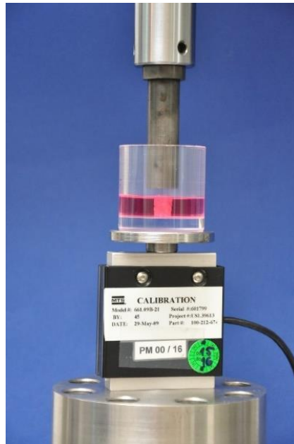
Obr. 4.6 Mechanické zkoušky vzorků v roztoku.
