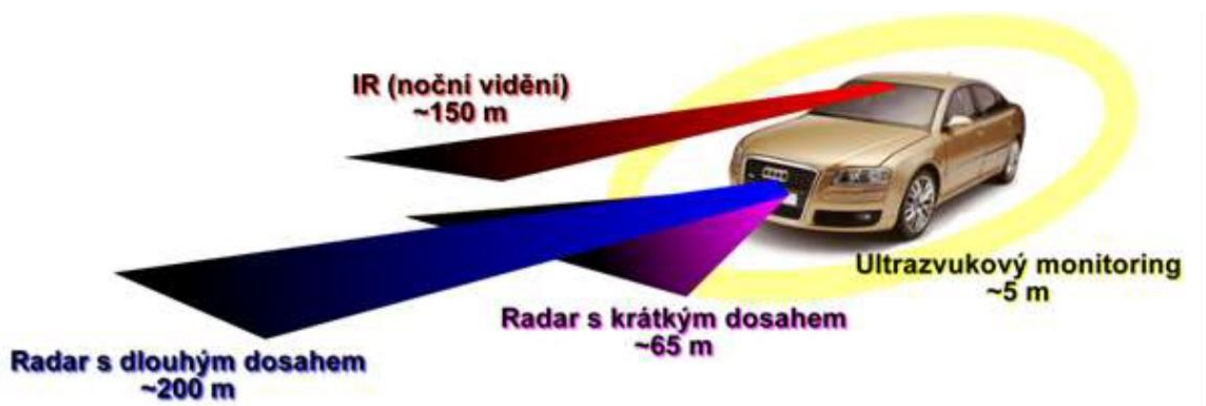
Obrázek č. 2.3: Systémy detekce okolí vozu a jejich délkový rozsah [3]
