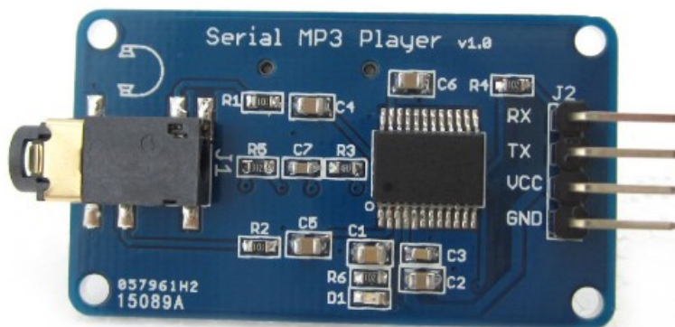
Obrázek 2.9: Catalex Serial MP3 module v1.0
