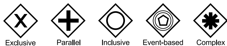
Obrázek 2.6: Typy rozhodovacích bran v BPMN
