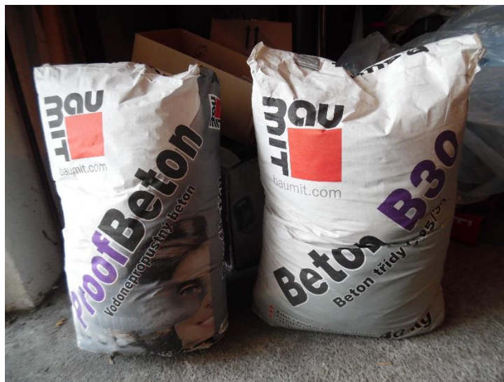
Obrázek 2.4 – Pytle průmyslově vyráběné betonové směsi pro betonové krychle 3. série, vlastní tvorba
