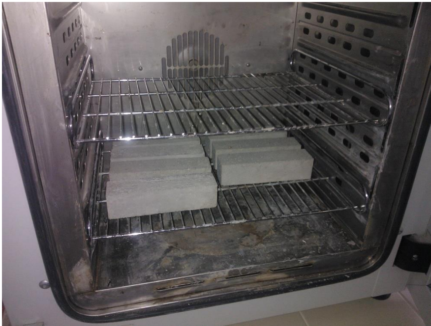
Obrázek 2.7 – Vysoušení betonových trámů v laboratorní sušárně, vlastní tvorba
