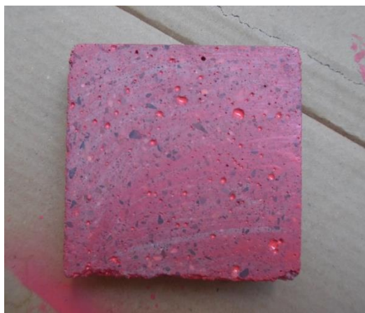
Obrázek 2.10 – Příprava výřezu betonové krychle pro obrazovou analýzu, vlastní tvorba
