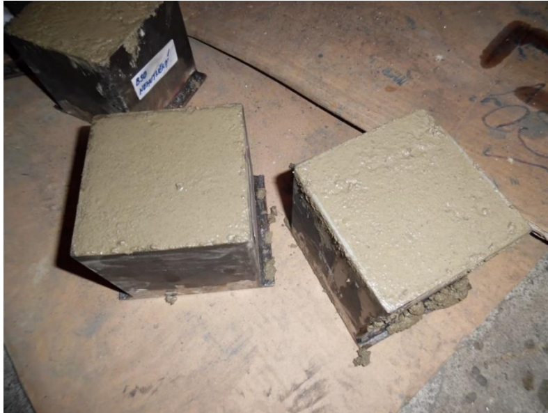
Obrázek 2.6 – Čerstvý beton uložený do bednicích forem, vlastní tvorba
