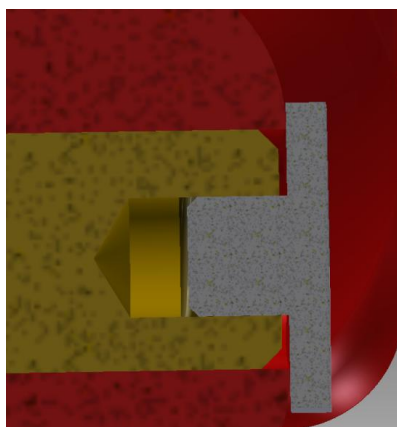
Obrázek č. 46: Řez axiálního zajištění kliky
