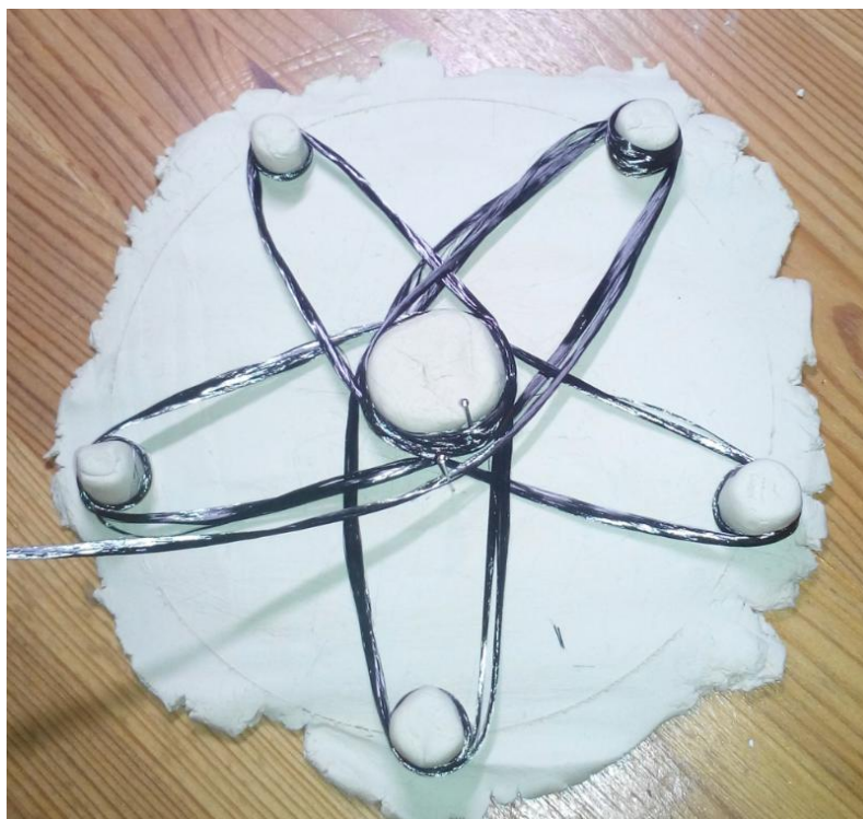
Obrázek č. 53: Praktická ukázka navinutí převodníku
