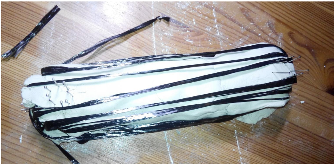
Obrázek č. 49: Ovinutí vrstvou o orientaci vláken \theta \cong 0^\circ
