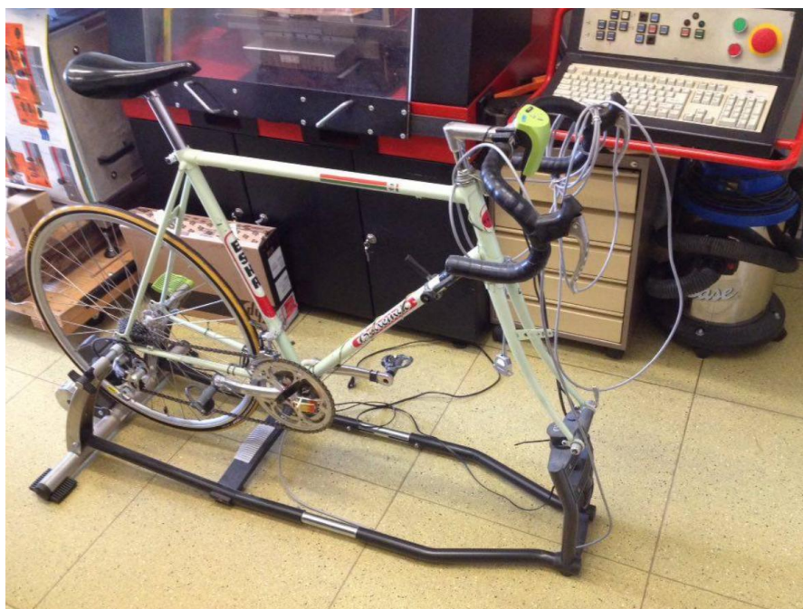
Obrázek č. 15: Jízdní trenažér pro měření zatížení kliky
