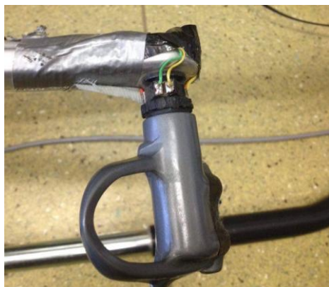
Obrázek č. 16: Detailní záběr na nalepené tenzometry
