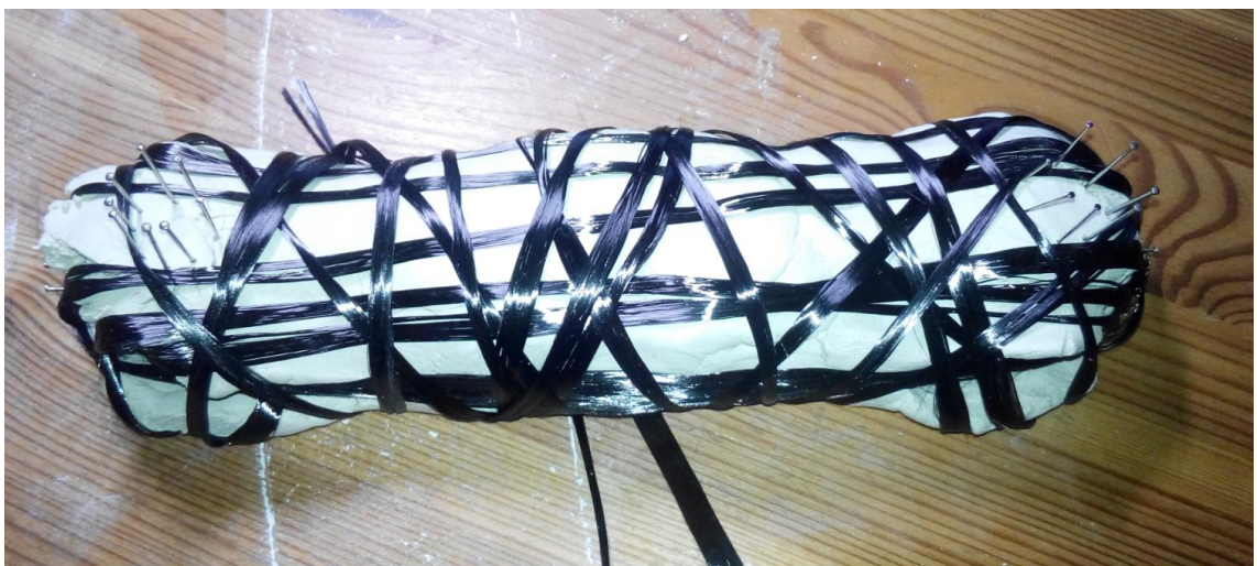
Obrázek č. 50: Ovinutí vrstvou o orientaci vláken \theta \cong \pm 45^\circ
