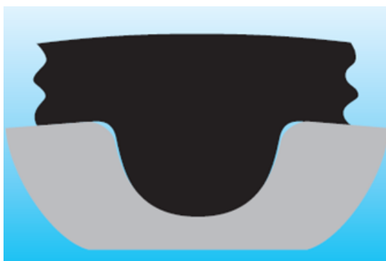
Obr. 21 Tvar ozubeného řemenu a řemenice GT2 [37]
