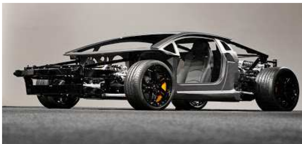
Obr. 3 Šasi Lamborghini z polymeru vyztuženého uhlíkovými vlákny [21]
