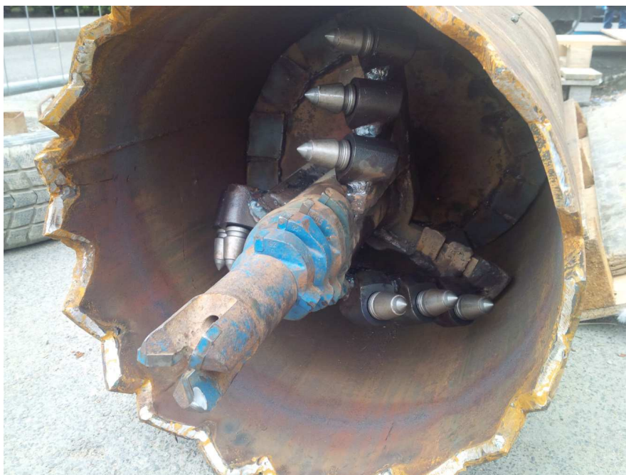
Obrázek 3.5 - Původní vrtná hlava, řezná hlava pro případné beranění
