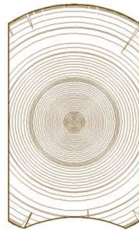
Obr. 3 Příčný řez kmenu používaného při norské technologii
