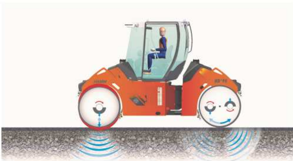
Obr. 5. 8 Schéma válce první skupiny s kombinovaným dynamickým účinkem
