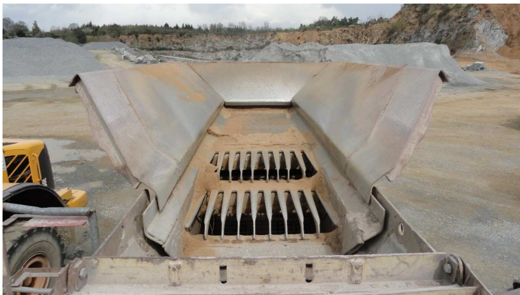
Obr. č. 9 Násypka s podavačem mobilního čelistového drtiče Metso Lokotract LT105
