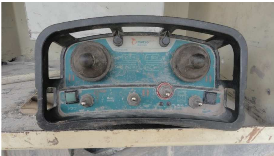
Obr. č. 10 Rádiové ovládání mobilního drtiče Metso Lokotract LT105
