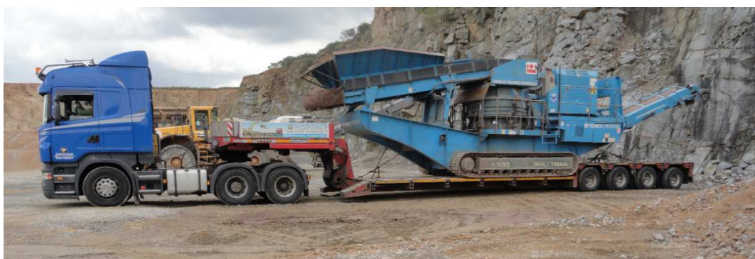
Obr. č. 15 Mobilní kuželový drtič Terex Pegson 1300 Maxtrack na podvalníku s tahačem
