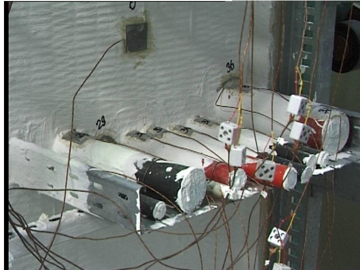
Obr. 44 Umístění termočlánků na neexponované straně
