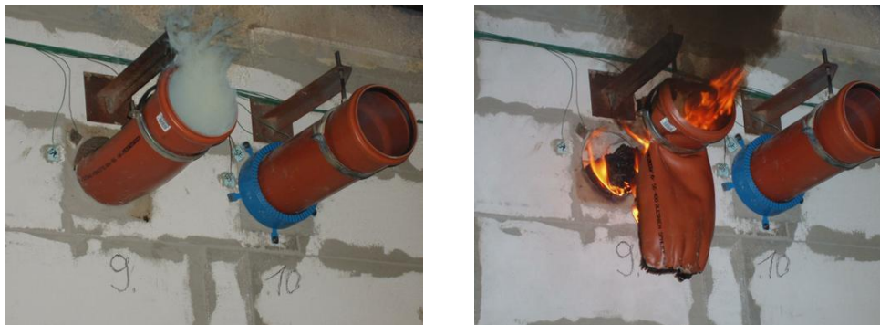
Obr. 56 Zkouška požární odolnosti (Levé potrubí není požárně utěsněné, Pravé potrubí je ošetřeno manžetou)
