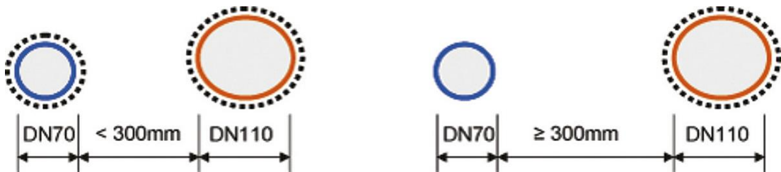
Obr. 42 Ucpávky u vzájemně blízkých prostupů
