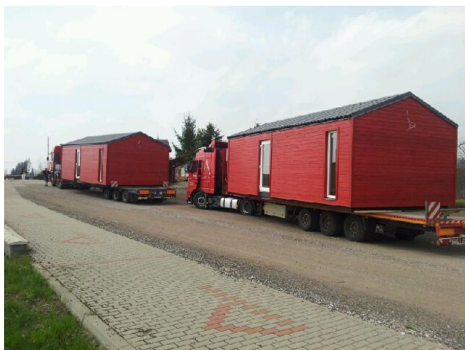
obr. 17 – Přeprava modulární dřevostavby WOODCON ( http://www.wood-con.cz/ [online]. [cit. 14.5.2016]. Dostupný na WWW: http://www.wood-con.cz/data/obsah_skryvany/7/20130423-140542.jpg )
