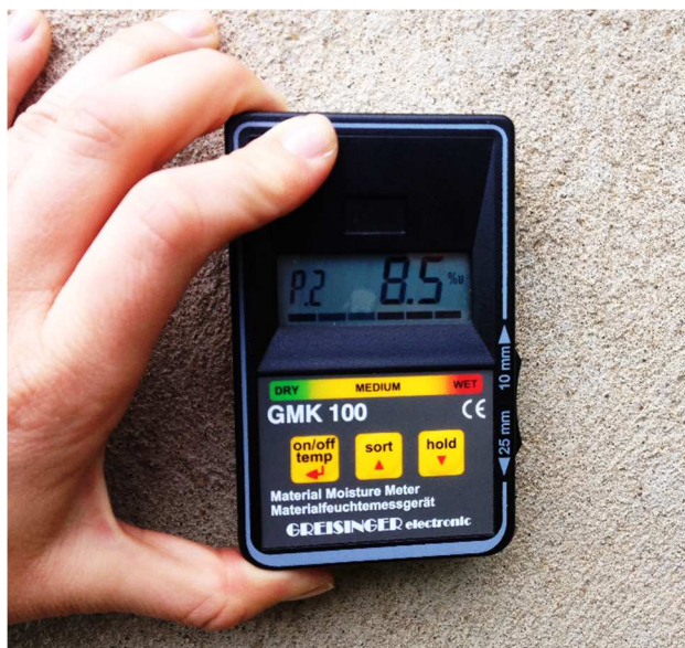
Obr. 3.7 Ukázka měření vlhkoměrem Greisinger Electronic GMK 100
