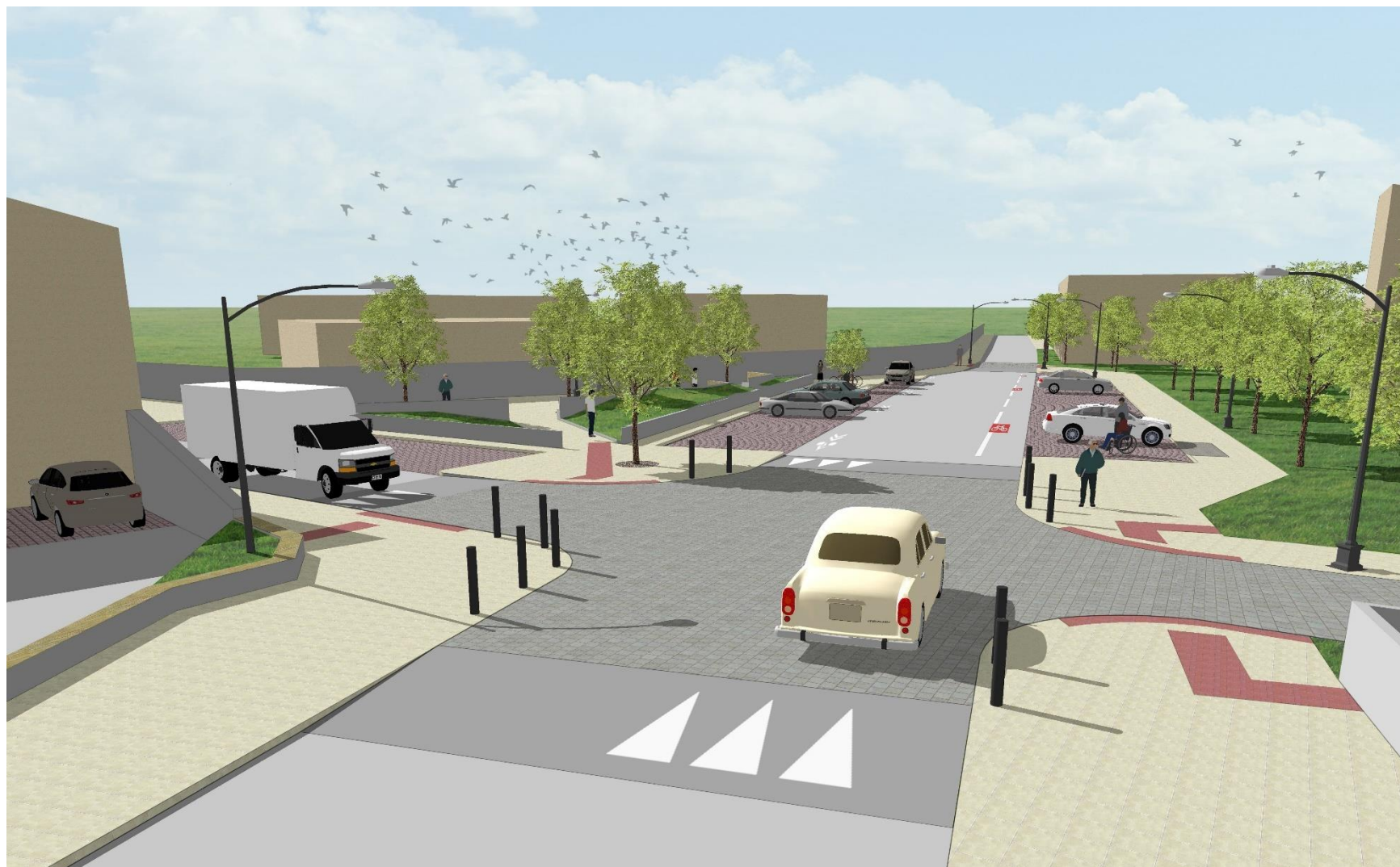
Obrázek 54 – Vizualizace zvýšené křižovatkové plochy 35
