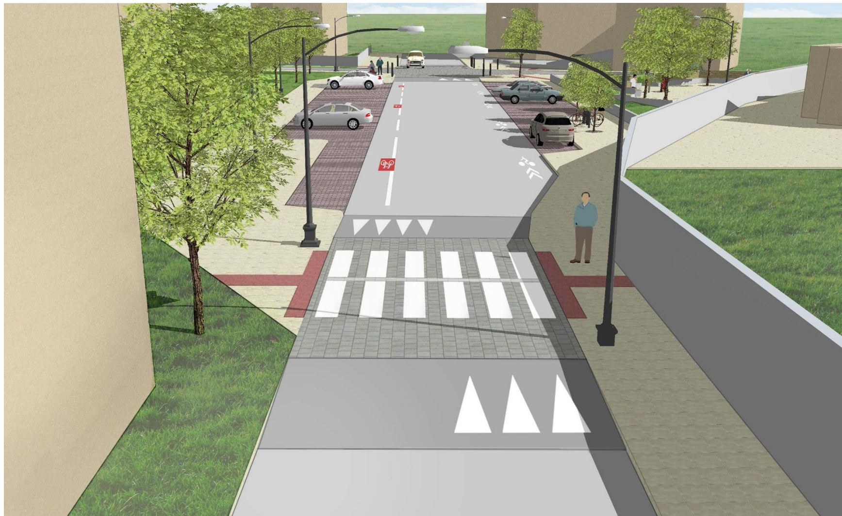
Obrázek 55 – Vizualizace integrovaného prahu s přechodem pro chodce 36
