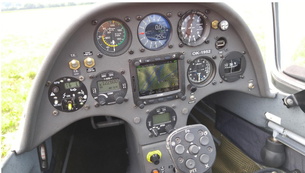
Obrázek 26: LX 8000 s variometrem V9 instalovaný v kluzáku Duo Discus XLT
