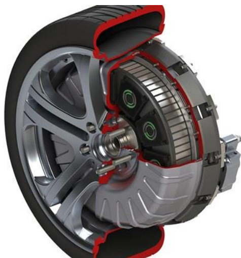
obrázek číslo 21. - schéma motoru v kole vozila
