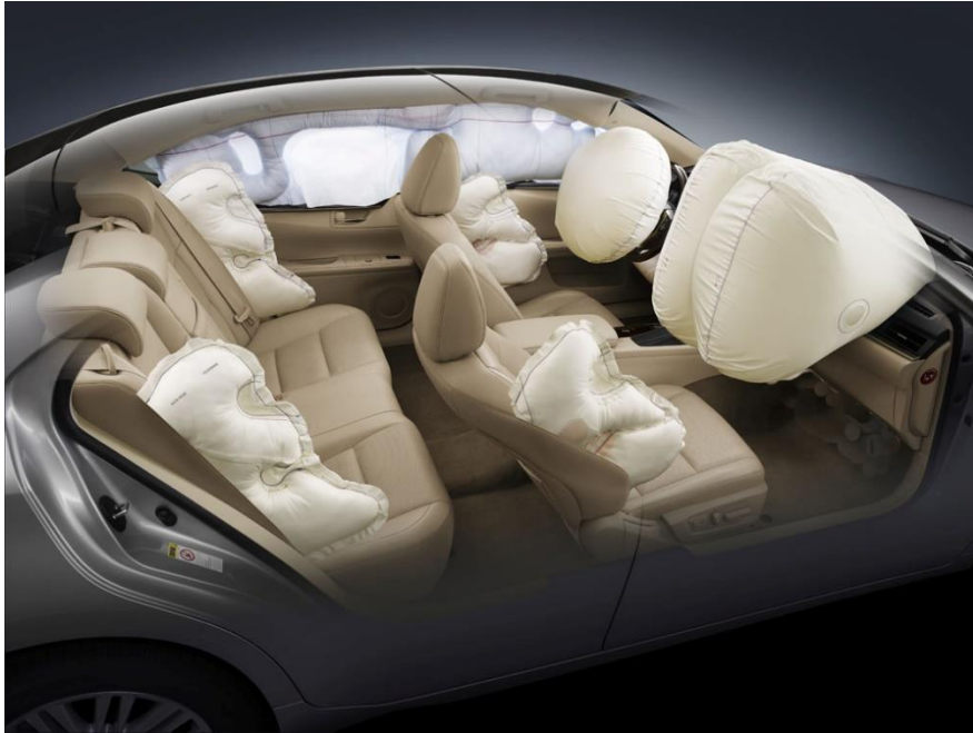
obrázek číslo 20. - nafukovací vaky (airbagy) v interiéru vozu
