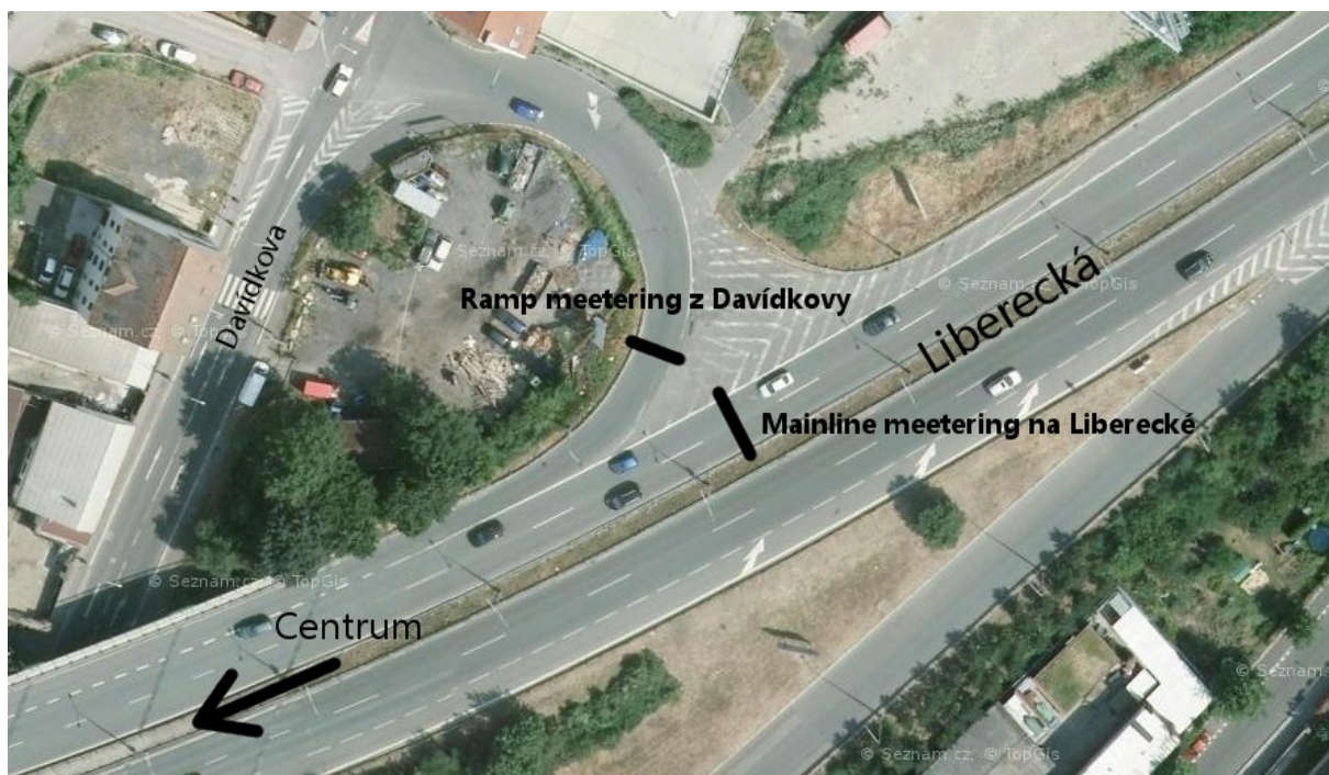
Obrázek 20 Schéma světelné závory ve variantě 1, zdroj podkladové mapy: mapy.cz, zdroj popisů vlastní
