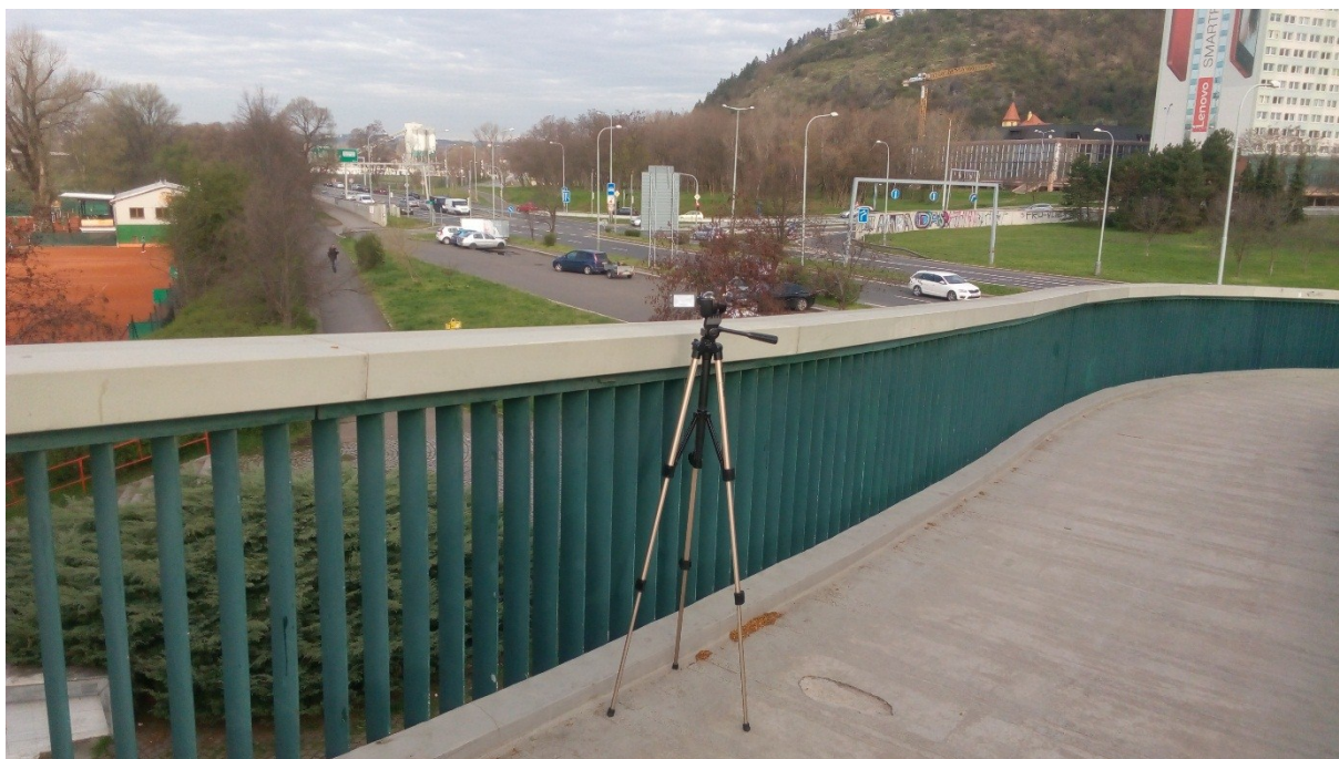
Obrázek 5 Zachycování provozu na světelné křižovatce Nová Povltavská x rampa ulice V Holešovičkách na kameru, zdroj vlastní
