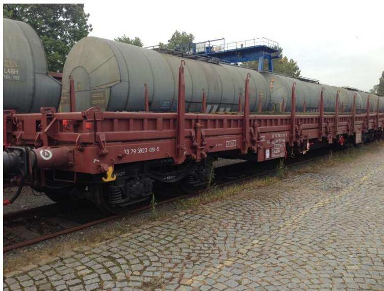
Obrázek 4: Čtyřnápravový nízkostěnný železniční vůz řady Res (foto Berečková)
