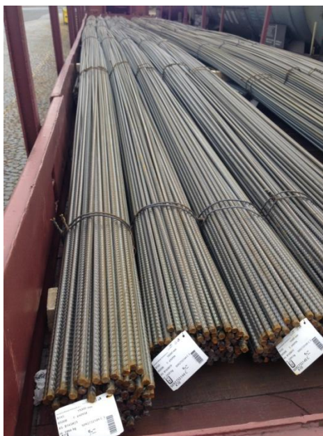
Obrázek 3: Betonářská ocel svazky (foto Berečková)
