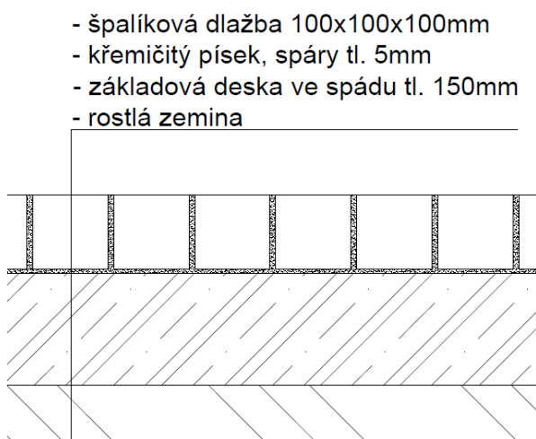
Obr. 17: Schéma skladby špalíkové dlažby (vlastní zdroj)
