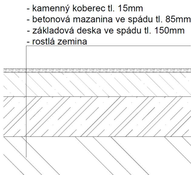
Obr. 22: Schéma skladby kamenného koberce (vlastní zdroj)
