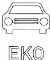
Obr. 4 – Symbol pro označení parkovacího stání vyhrazeného pro vozidla šetrná k životnímu prostředí.
